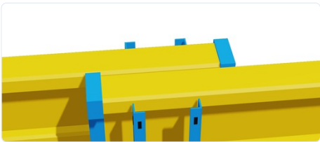
СТЫК · ПАЗ 170 мм Две балки рядом, заход за ось ≥ 150 мм — стр. 25 .
